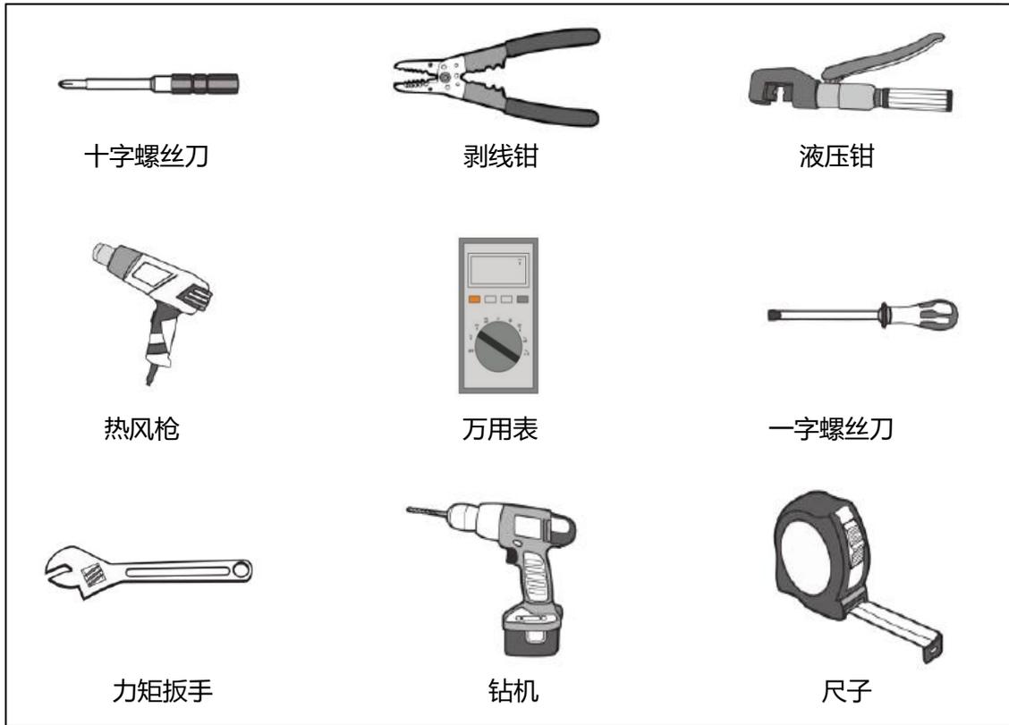
图 5-10 安装工具
