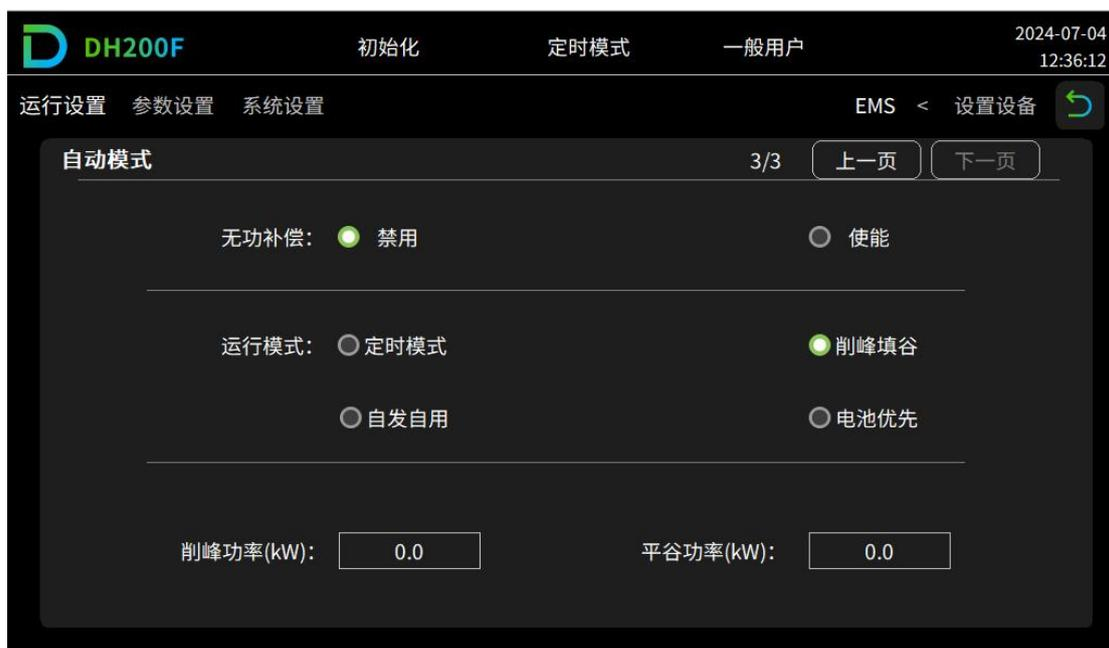
图7-16 削峰填谷设置示意图
